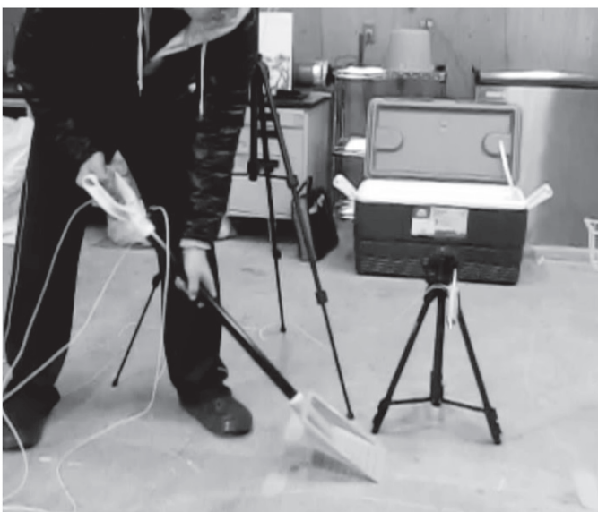
図-3 スコップが地面上を撓動する時の音の計測の様子
